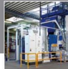
Strahlanlage Blasting plant
